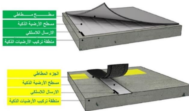
صورة رقم ( 15 ) توضح مكونات الأرضيات التفاعلية باستخدام المواد الكهرو ضغطية (34)
